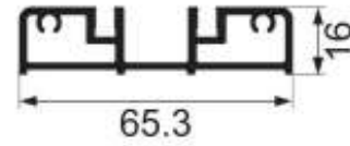
JY-75ZD-06 low track Weight : 0.96 kg/m
